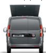
Uchylny dach nad przestrzenią ładunkową (opcja 585), dostępny tylko w wersjach z dwuskrzydłowymi drzwiami tylnymi, pełnymi lub przeszklonymi
