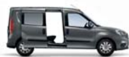
Kombi Maxi częściowo przeszklony z przesuwными, przeszklonymi bocznymi drzwiami po obu stronach i pełnym bokiem za tylnym rzędem foteli (opcja 526)
