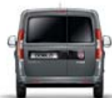
Tylne drzwi, dwuskrzydłowe, przeszklone
